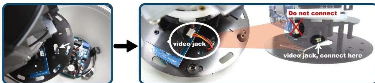
Установите модуль камеры внутрь кожуха, протянув кабель видео/питания через отверстия рядом с платой в модуле камеры.
