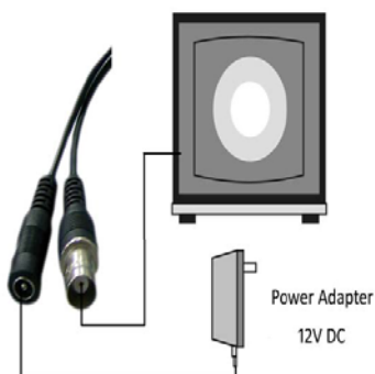
Рис. 5.1. Коммутация разъемов видеокамеры
